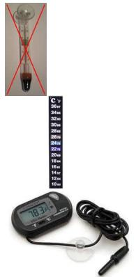
Stakleni termometar, LCD termometar i digitalni termometar sa sondom
